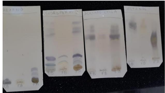
Figura 1. Placas cromatográficas reveladas com vanilina sulfurica.
